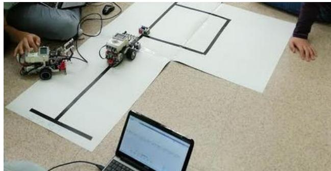
Učenci se bodo pri predmetu seznanili z osnovami konstrukcije tipičnih oblik robotskih rok, z elektronskim krmiljenjem in različnimi senzorji, ki omogočajo povratno delovanje krmiljenja. Učenci se seznanijo z računalniškim programiranjem, s katerim bodo omogočili vodenje svojih robotov. To znanje bodo pridobili z uporabo didaktičnih zbirke Lego Mindstorms, LEGO SPIKE Essential, LEGO SPIKE Prime.
